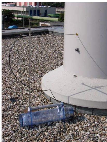
Figura 2. Ejemplo del sistema pulmón diseñado para la recogida de muestras
