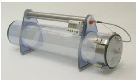
Figura 2. Ejemplo del sistema pulmón diseñado para la recogida de muestras
